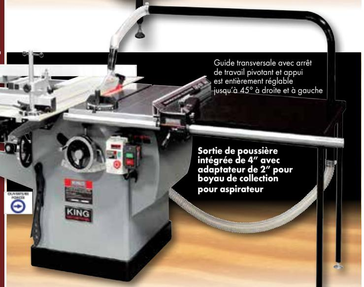
Guide transversale avec arrêt de travail pivotant et appui est entièrement réglable jusqu'à 45° à droite et à gauche
